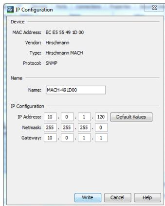
*Figura 105: Configuración IP de un dispositivo*
