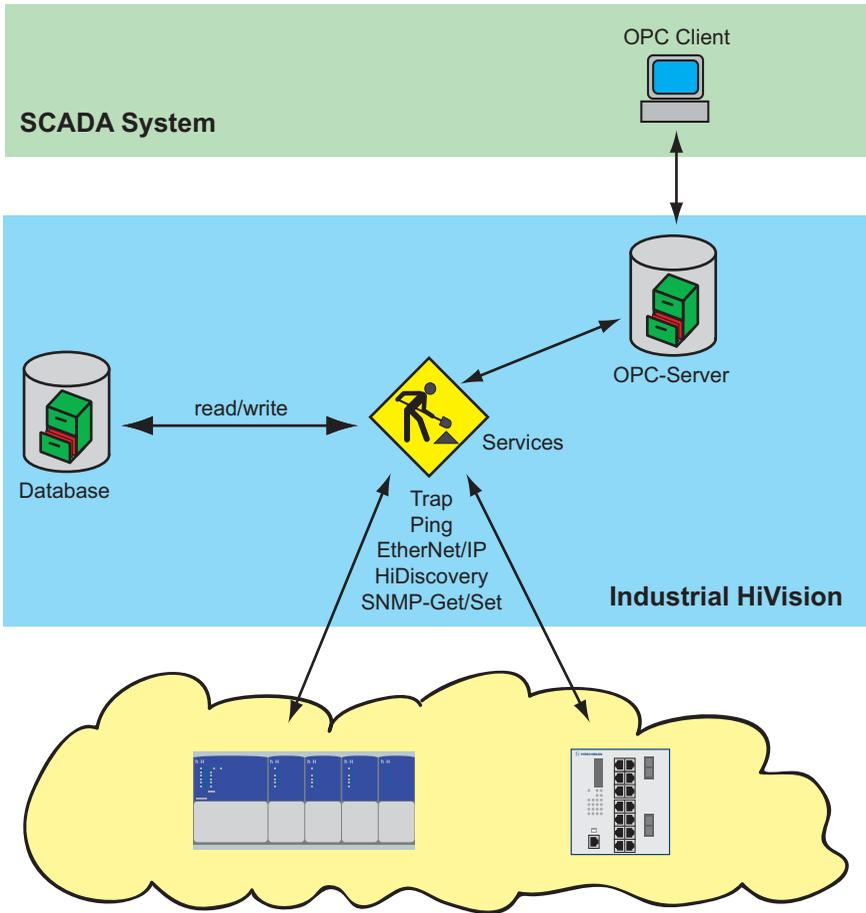
Figura 49: Conexión con el sistema de visualización de procesos
