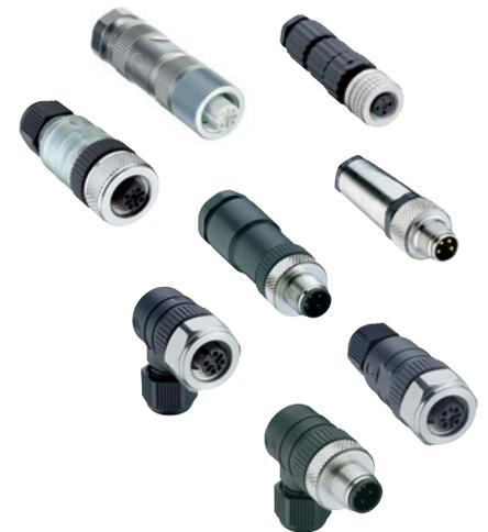
Die Gehäuse der M8- und M12-Steckverbinder stehen als Kunststoff- und Metallausführungen zur Verfügung. In Kombination mit der Steuerleitung STL 500 beträgt der Nennstrom bei den vierpoligen konfektionierbaren Steckverbindern 4 A (bei 40°C). Die Bemessungs- und die Prüfspannung liegen – je nach Ausführung – zwischen 30 und 240 V bzw. 0,8 und 2,5 kV (eff./60 s). Der Isolationswiderstand ist  $>10^9 \Omega$ .
